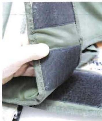
تستعمل ألياف النايلون في صناعة أشرطة التثبيت. خيوط النايلون يمكن سحبها من سطح المحلول.
