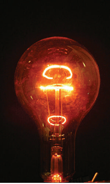
الشكل ١٤ يستخدم العنصر الانتقالي التنجستون في مصابيح الإنارة بسبب ارتفاع درجة انصهاره.
