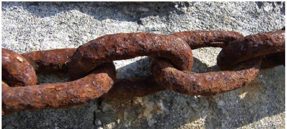
الشكل 2 يتأثر الحديد بالرطوبة والهواء، ويتحول إلى مركب جديد يُسمى أكسيد الحديد III.
