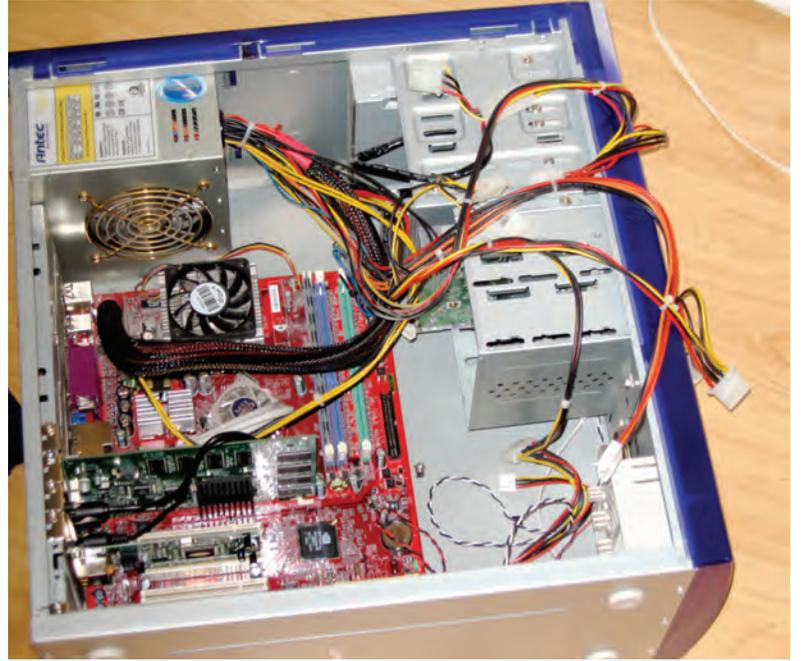
الشكل 13 تستخدم المروحة للتخلص من الطاقة الحرارية الناتجة في أجزاء الحاسوب.
