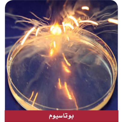
الشكل 9 تتفاعل الفلزات مع الماء، ويصاحب التفاعلات انطلاق غاز الهيدروجين وانبعاث طاقة حرارية.
