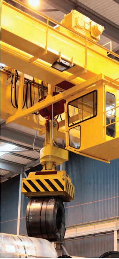
الشكل 7 يستخدم المغناطيس الكهربائي لرفع الأجسام الفلزية التي لها قابلية الانجذاب إلى المغناطيس.
