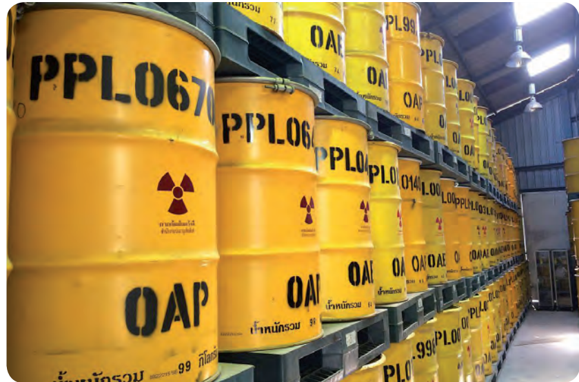
■ الشكل 23-6 يوضح كيفية حفظ النفايات المشعة في محطات القوى النووية.
