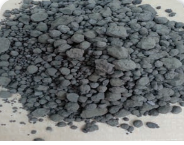
الشكل 26-7 الكلنكر هو المادة الأولية في صناعة الأسمنت، وتنتج من تفاعل الطين مع الحجر الجيري في ظروف خاصة.
