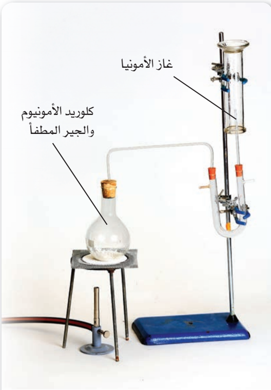
الشكل 4-7 يُظهر الجهاز المستخدم في تحضير غاز الأمونيا بتسخين كلوريد الأمونيوم مع الجير المطفأ (هيدروكسيد الكالسيوم)، ثم تمرير الأمونيا الناتج خلال برج التجفيف الذي يحتوي على الجير الحي (أكسيد الكالسيوم).
