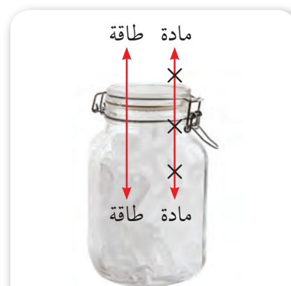
الشكل 3-6 في النظام المغلق، يتم التبادل في الطاقة فقط مع المحيط ولا يتم تبادل المادة.
